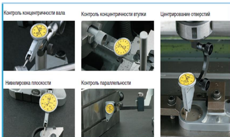
Рисунок 143 – Применение индикатора ИРБ
