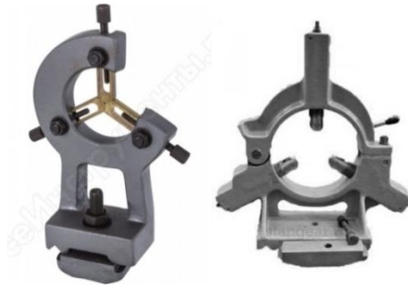
Рисунок 81в - Приспособления для крепления заготовок типа тел вращения на станках (люнеты)
