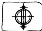
Рисунок 96 - Пример стопорения деформацией металла
