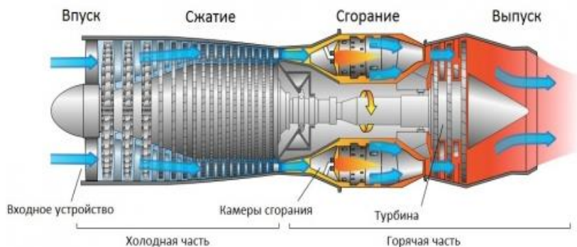
Рисунок 1 - Газотурбинный двигатель (ГТД)
