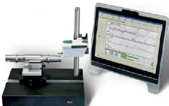
Рисунок 182 – Прибор измерения шероховатости поверхности (профилометр, профилограф)
