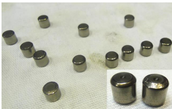
Рисунок 3. Дефекты на телах качения роликоподшипника
