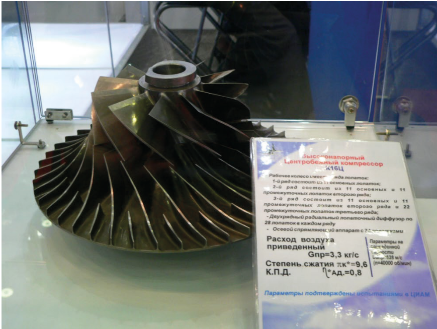
Рисунок 2. Центробежная ступень на степень повышения давления 9,6
