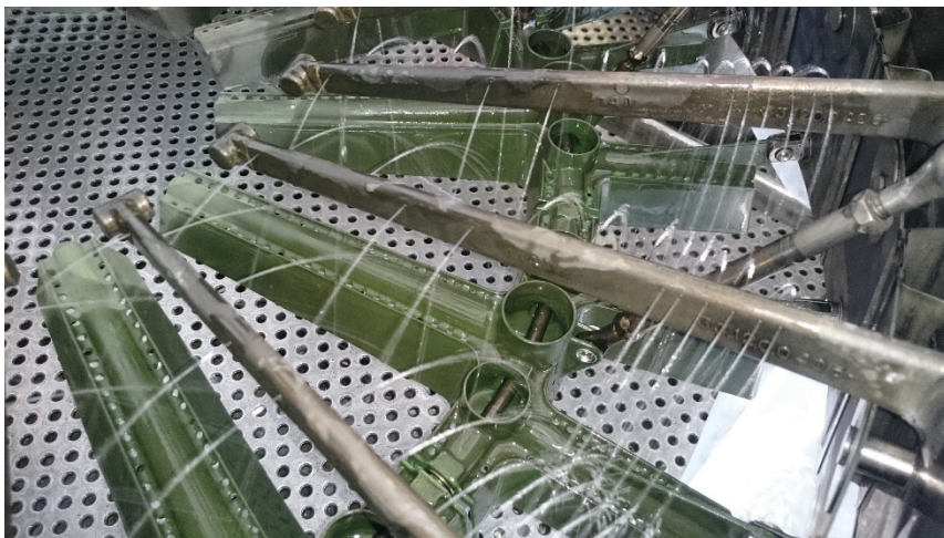
Рисунок 2. Струи топлива из 3-го коллектора при малом давлении
