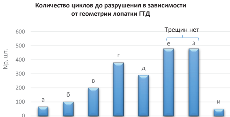
Рисунок 3б. Результаты испытаний на термостойкость лопаток различных форм из сплава ЖС6К
