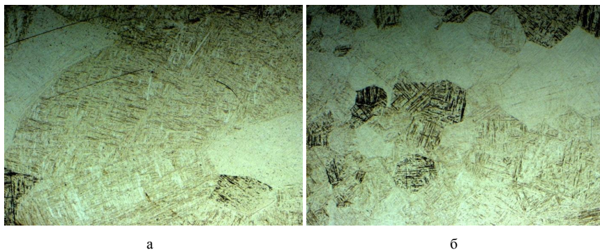
Рис. 1. Микроструктура центра шва соединений титанового сплава OT4-1, \times 50 : а — традиционный способ сварки; б — инновационный способ сварки
