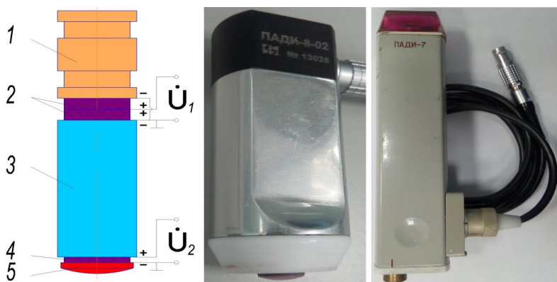
Рис. 1. Конструктивная схема и внешний вид датчиков ПАДИ-8-02 и ПАДИ-7:
