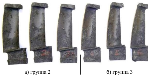
Рис. 3. Вид отливок после испытаний в среде с морской солью — ОХК
