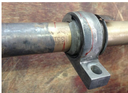
Рис. 2. Выработка материала на поверхности трубопровода и выступание ленты пластинчатого демпфера
