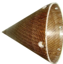
Рис. 2, б. Входной обтекатель ВНА из ПКМ на термопластичной матрице
