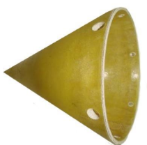
Рис. 2, а. Входной обтекатель ВНА из ПКМ на матрице из реактопласта
