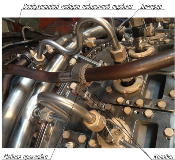
Рис 5. Экспериментальная установка демпфирующего элемента из материала МР в опору воздухопровода двигателя НК-37
