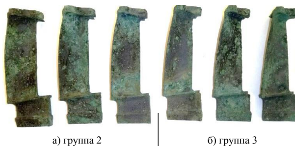
Рис. 2. Вид отливок после испытаний в среде 75 % \text{Na}_2\text{SO}_4 + 25\% \text{NaCl} (10 циклов) — ОСК
