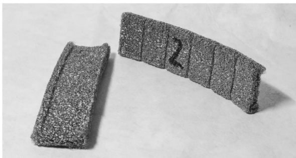
Рис. 3. Упругодемпфирующий элемент из материала МР
