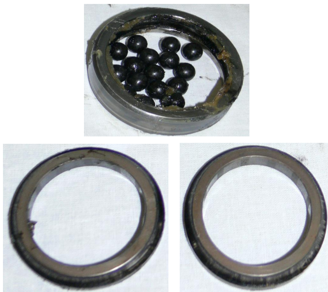
Рис. 3. Подшипник типоразмера 126208 без сепаратора с керамическими шариками
