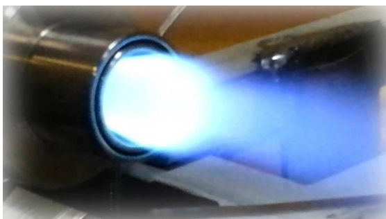
Рис. 3. Вид факела при работе предкамеры без использования внешнего завихрителя
