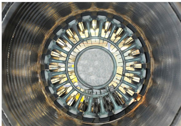
Рис. 5. Фронтное устройство с радиальными распылителями форсажной камеры двигателя F100-PW-220
