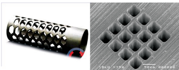
Рис. 3. Слева — лазерно-вырезанный тонкостенный фильтр (стенки 1 мм, d10), справа — упорядоченные отверстия 50 мкм в нитриде кремния без кратеров. (50 \mu\text{m} square holes in SiN, image courtesy of oxford lasers) [3]
