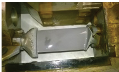
Рис. 2. Заготовка лопатки до ЭХО
