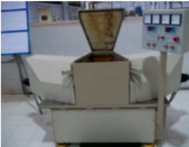
Рис. 4. Станок ЭХО «Искра ЛТ»
