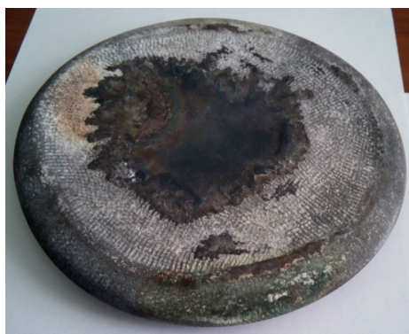
Рис. 3. Осажденная в квазиизотермических условиях заготовка из сплава ЭП741НП с деформацией около 68%
