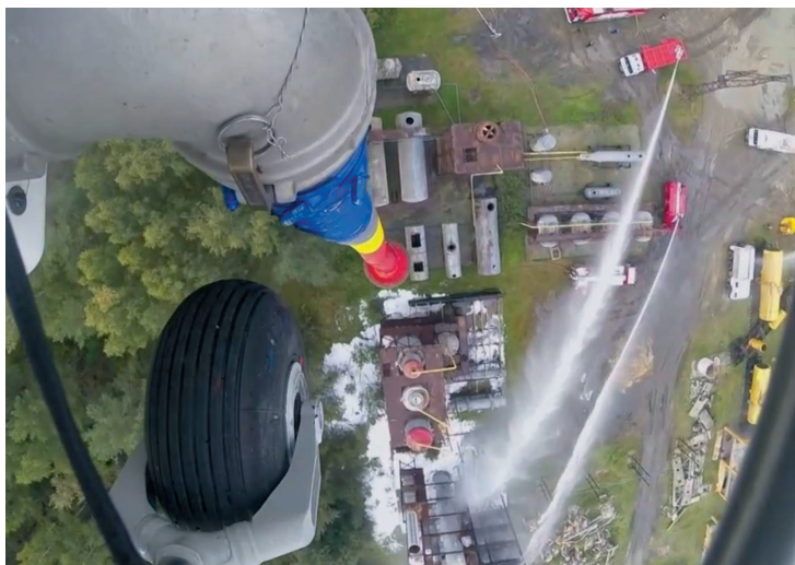
Рис. 7. Сравнительная дальность струи СГТ и обычной системы. Снимок с вертолета на демонстрации системы в г. Ногинске.
