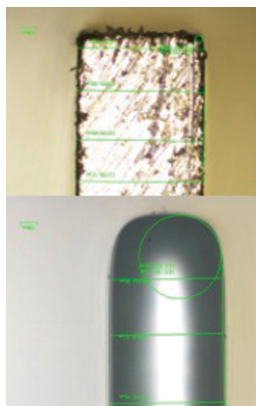
Рис. 14. Кромка образца из ВТ6 до и после операции ЭПП
