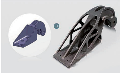
Рис. 1. Шарнирное крепление до и после оптимизации конструкции под аддитивное производство [11]
