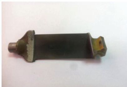
Рис. 12. Лопатка после ЭХО
