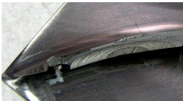
Рис. 2. Излом лопатки по вскрытой трещине
