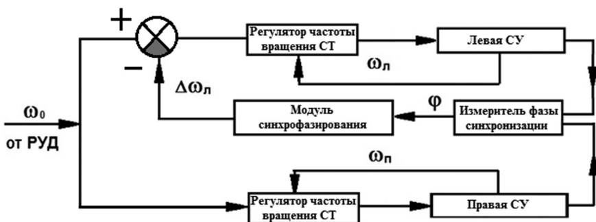
Рис. 1. Система управления силовой установкой с асимметричной схемой синхροфазирования:
