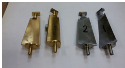
Рис. 9. Вид мастер-лопаток и статорных лопаток после ЭХО
