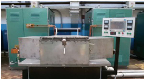
Рис. 7. Станок «Искра 38.5.1» с площадью обработки до 200 см 2
