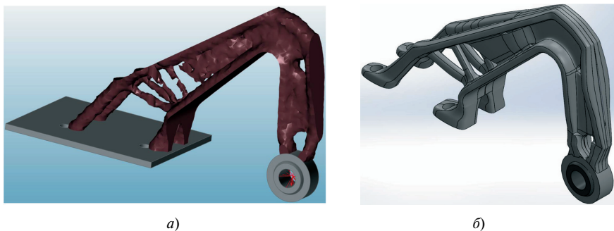
Рис. 6. Выбранный вариант топологической оптимизации и конечная 3D модель
