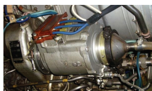
Б. Стартёр-генератор с напряжением =270В
