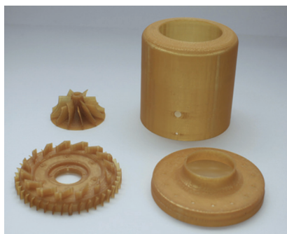
Рис. 5. Детали МГТД, изготовленные методом FDM
