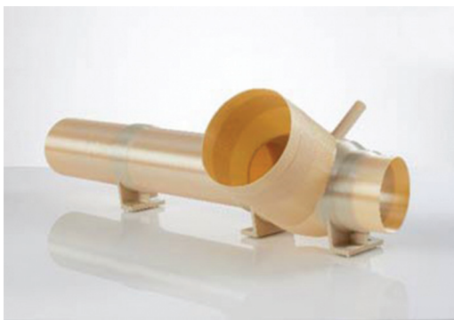
Рис. 1. Элемент ракеты-носителя Atlas V, изготовленный из пластика ULTEM 9085
