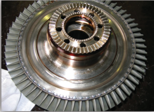
Рис. 2. Внешний вид образца — демонстратора рабочего колеса турбины вертолетного двигателя конструкции типа «блиск», выполненный с применением технологии пайки.
