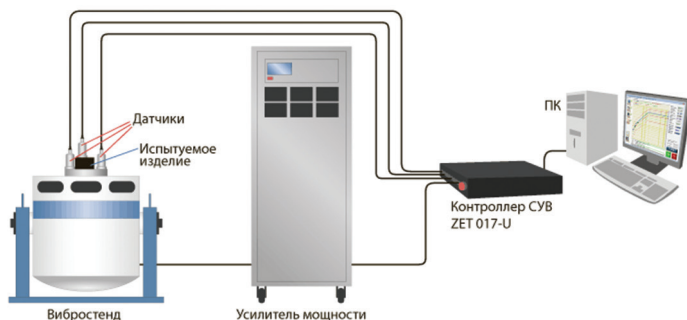
Рис. 3. Схема соединения оборудования для испытаний
