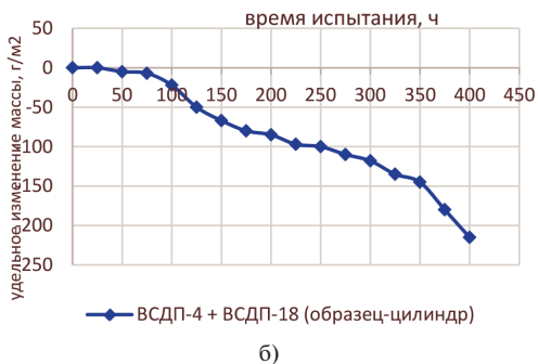
Рис. 3. Результаты испытаний на циклическую жаростойкость в интервале температур 1150↔ 200°С а) круглые образцы; б) цилиндрические образцы
