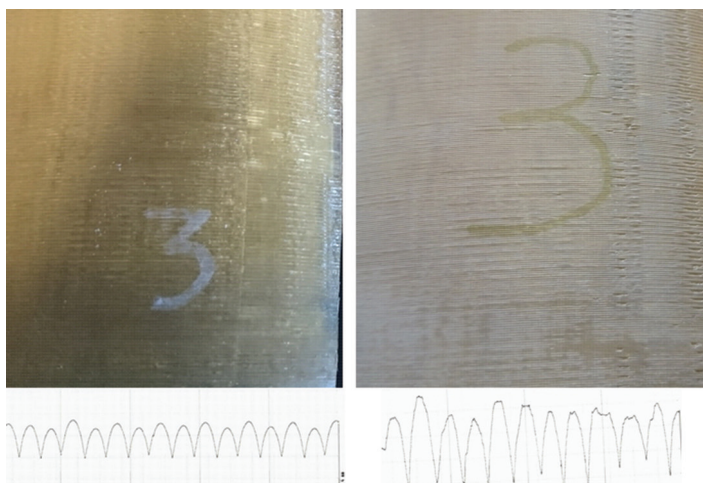
Рис. 8. Внешний вид и профиль шероховатости образца до и после обработки тонкой фракцией
