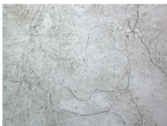
Рис. 5. Микроструктура литого материала коррозионностойкой стали, СМ, \times 500
