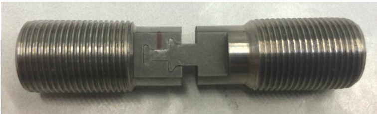
Рис. 7. Модельный образец для проверки прочности паяного соединения «диск-лопатка» в сборе перед пайкой
