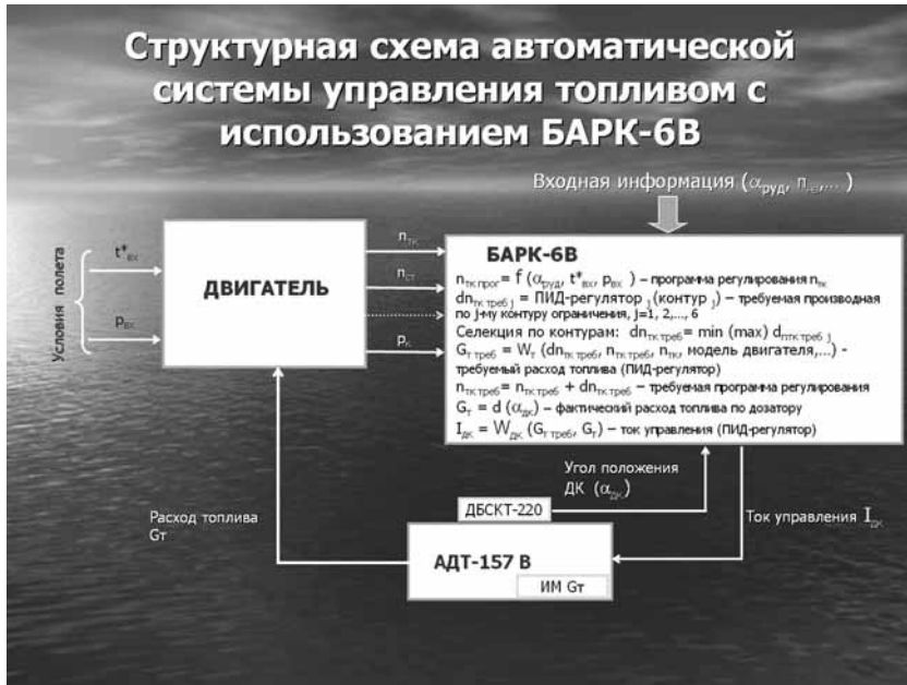
Рис. 1. Общая структурная схема существующей автоматической системы управления топливом для двигателя ТВ7-117В
