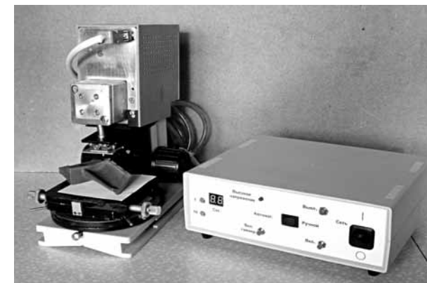
Рис. 3. Установка РДУ «КРОС-3» для определения кристаллографической ориентировки монокристаллов
