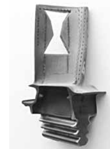
Рис. 4. Лопатка турбины после вырезки заготовок для моделей
