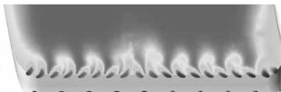
Рис. 6. T^*/T^*_{\text{макс}} в плоскости второго ряда отверстий со стороны корыта, ( L = 0 )
