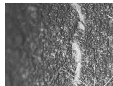
Рис. 2. Разрушение керамического ТЗП на рабочей лопатке турбины
