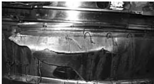
Рис. 5. Корпус вентилятора после испытаний
