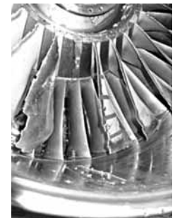
Рис. 4. Ротор вентилятора после испытаний
