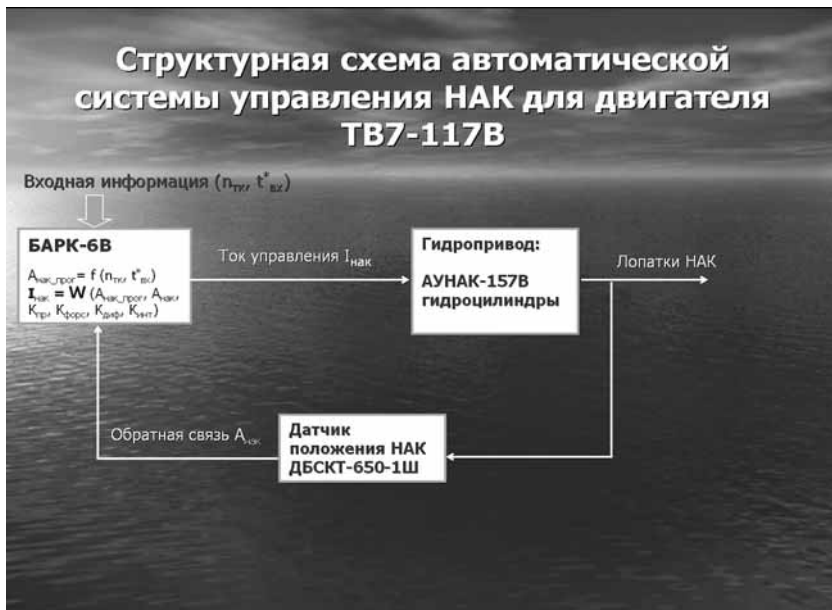
Рис. 2. Общая структурная схема автоматической системы управления НАК для двигателя ТВ7-117В
