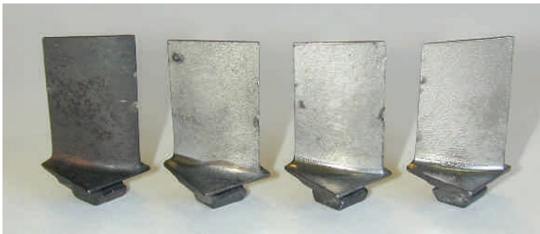
Рис. 5. Внешний вид лопаток из стали ЭП866Ш после 260-часовой эксплуатации на двигателе РД-33 и облучения двумя импульсами на ускорителях «GESA-1»: слева направо — исходная лопатка после наработки, w = 20–22, 26–28 и 32–36 Дж/см 2
