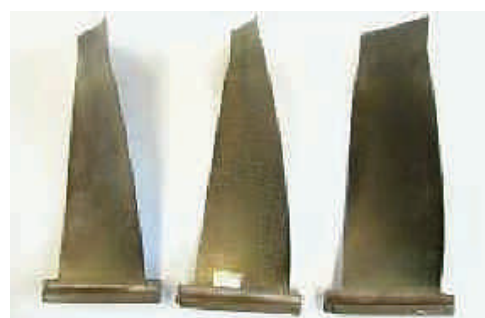
Рис. 5. Общий вид образцов-лопаток после горячей закрутки
