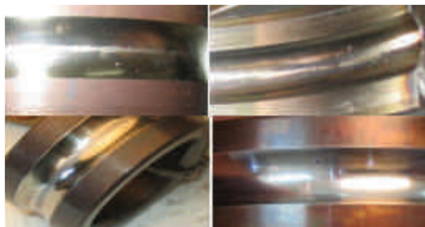
Рис. 4. Характерные дефекты в подшипниках качения
