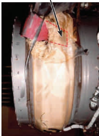
Рис. 2. Удержание корпусом вентилятора оборвавшейся лопадки
