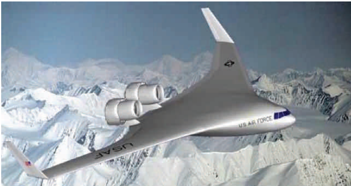
Рис.4. Компоновка силовой установки с трехконтурным турбореактивным двигателем на перспективном летательном аппарате
