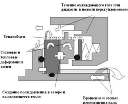
Рис. 2. Основные проблемы, возникающие при проектировании уплотнений
