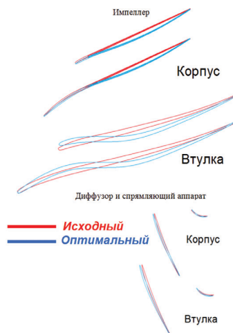
Рис. 11. Геометрическая форма профиля исходного и оптимального вариантов компрессора
