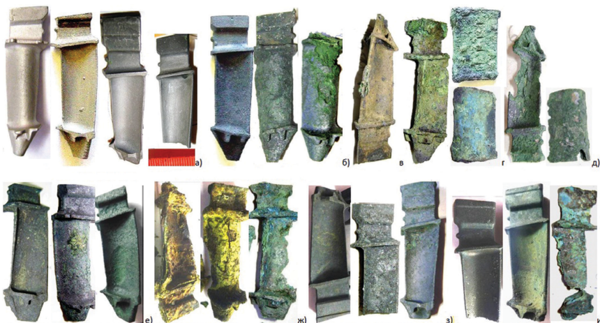
Рис. 3. Внешний вид рабочих и сопловых лопаток РЛ1 (литье ОАО «Климов», без покрытий): а — в исходном состоянии для коррозионных испытаний, б-и — после 30 циклов коррозионных испытаний: б — сплав ЖС6К, среда морская соль, 750, 850 и 950°С; в — сплав ЖС6К, среда 75%Na 2 SO 4 +25%NaCl, 750°С; г — сплав ЖС6К, среда 75%Na 2 SO 4 +25%NaCl, 850°С; д — сплав ЖС6К, среда — 75%Na 2 SO 4 +25%NaCl, 950°С; е — сплав ВКНА-25, среда — морская соль, 750°С, 850°С и 950°С; ж — сплав ВКНА-25, среда — 75%Na 2 SO 4 +25%NaCl, 750°С, 850°С и 950°С; з — сплав ЖС32, среда — морская соль, 750°С, 850°С и 950°С; и — сплав ЖС32, среда — 75%Na 2 SO 4 +25%NaCl, 750°С, 850°С и 950°С.
