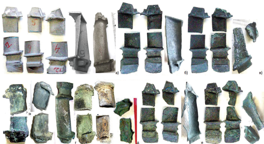
Рис. 4. Внешний вид рабочих лопаток РЛ1 из новых сплавов ВЖМ-5у, ВЖМ-8, ВЖМ-4 (литье ОАО «Климов», без покрытий)
