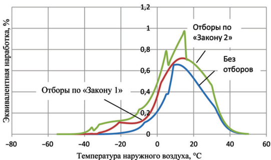
Рис. 4. Распределение эквивалентной наработки двигателя по температуре наружного воздуха
