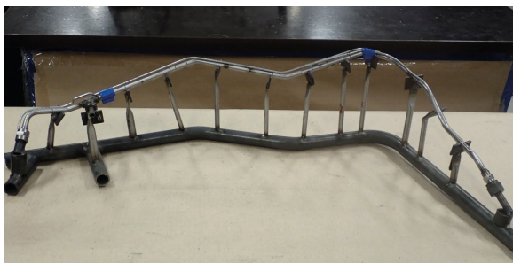
Рисунок 2. Контрольный образец трубопровода на стапеле
