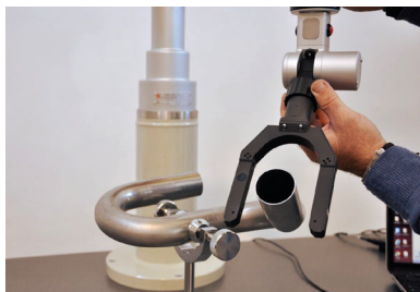
Рисунок 4. Контроль конфигурации трубопровода с помощью КИМ
