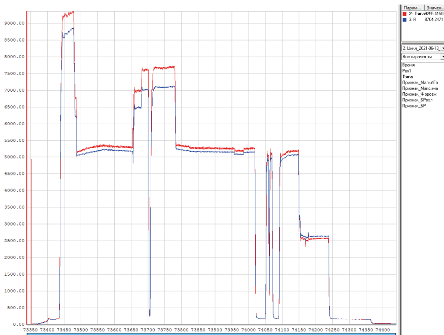
Рисунок 8. Работа модели в ПО «Диагностика» (цикл третьего этапа ресурсных испытаний, красная линия — результаты посчитанные по разработанной модели, синяя линия — практические значения)
