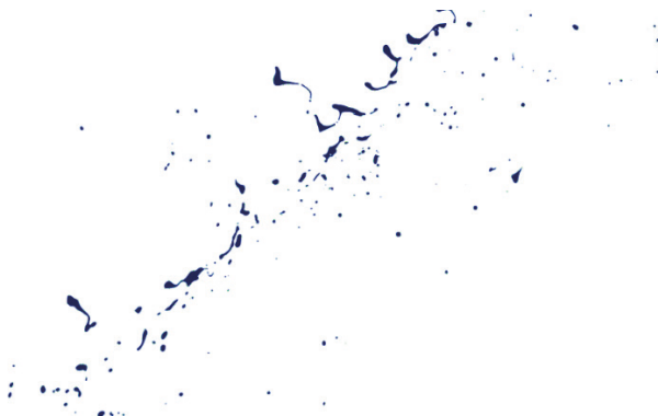
Рисунок 7. Сгустки жидкости в сечении конуса распыла на расстоянии 9–12 мм от форсунки
