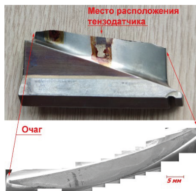
Рисунок 3. Общий вид разрушенной лопатки и излома
