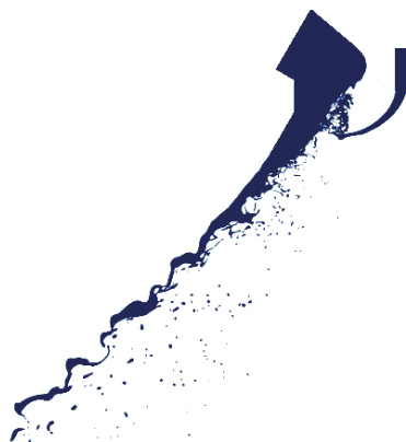
Рисунок 9. Распределение жидкости в сечении вблизи форсунки
