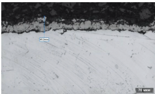
Рисунок 11. Микроструктура образца с покрытием после 800 циклов
