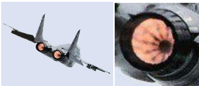
Рисунок 1. Видимые зоны отсутствия горения ТВС за стабилизаторами и коком турбин
