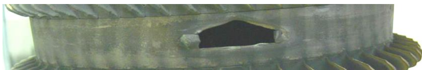
Рисунок 2. Сквозное расплавление ротора
