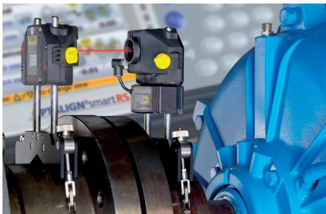
Рисунок 4. Монтаж лазерной центровки OPTALIGN Smart на валу изделия
