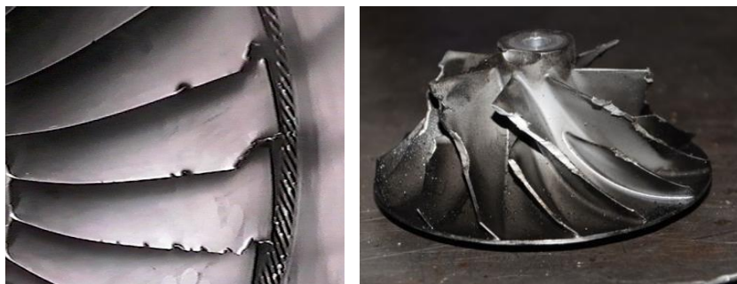
Рисунок 1. Детали компрессора ГТД с эксплуатационными дефектами: по материалам www/industr-avia/Olympus.co.ru
