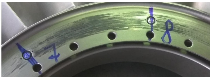
Рисунок 5. Следы касания датчиков ДЧВ о плоскость 1РК
