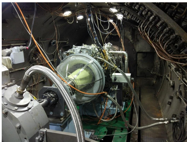
Рисунок 1. Компоновка двигателя ТВ7-117В гидротормозом на подмоторной раме стенда
